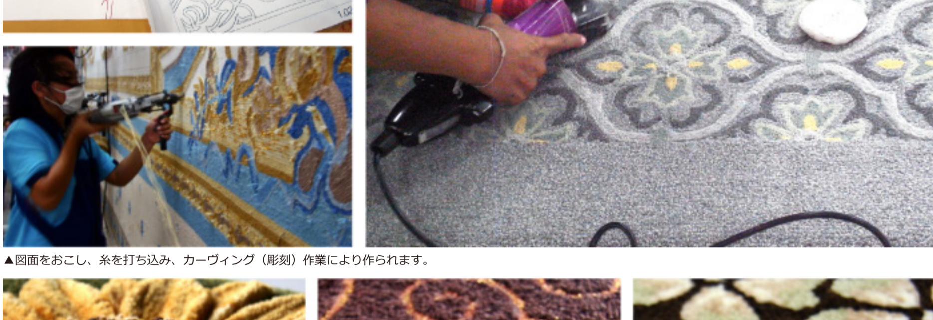
▲図面をおこし、糸を打ち込み、カービング（彫刻）作業により作られます。
