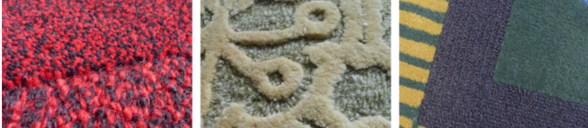
▲カットパイルとループパイルは同じ色糸でも色や光沢の見え方が違い、組み合わせることでアクセントや動きが生まれます。
