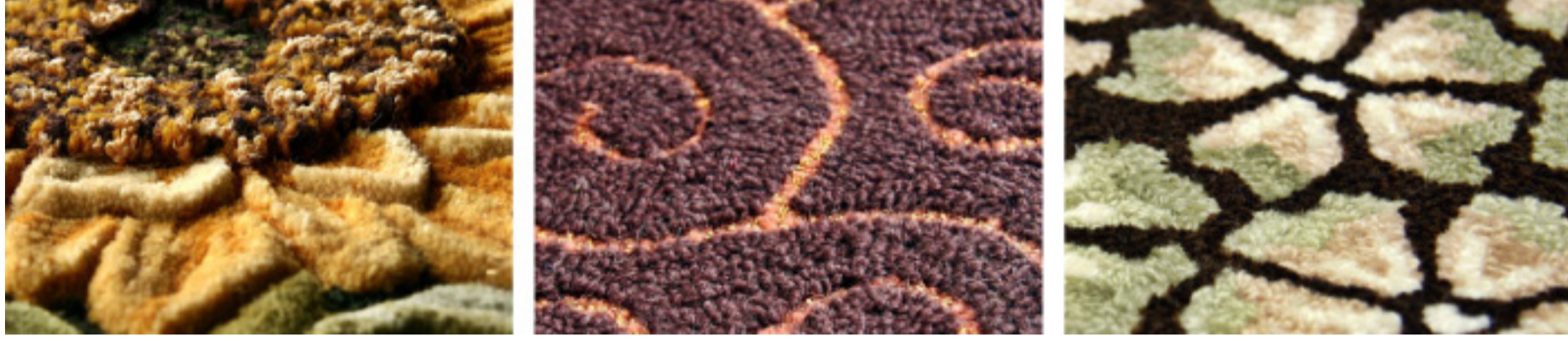
▲図面をおこし、糸を打ち込み、カービング（彫刻）作業により作られます。
