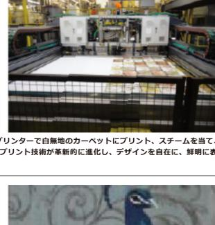
▲プリントカーペットは、赤・青・黄の3原色を元に色を調合し、水やグルーなどを加え粘度を調整します。大きな染色プリンターで白無地のカーペットにプリント、スチームを当て、水洗いして乾燥させます。弊社のサプライヤー数社も、最新鋭のデジタルプリント機を導入しています。ドットが細かく、プリント技術が革新的に進化し、デザインを自在に、鮮明に表現できるようになっています。
