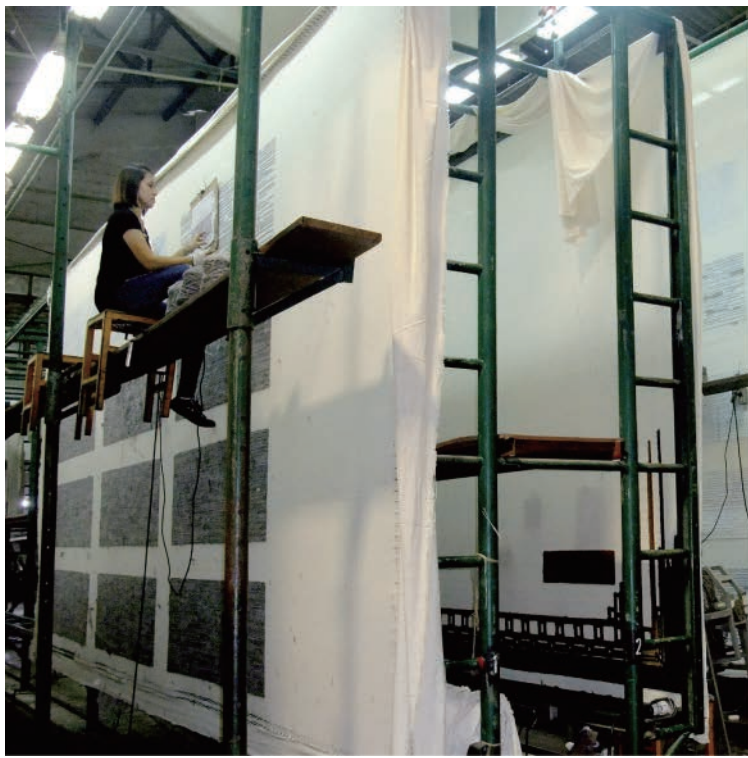
▲作業の様子。裏加工をし、パイルを打ち込み、カーヴィング(彫刻)する。卓越したカーヴィング技術によりバンブー糸なら1色でも表情豊かに。(右上)
